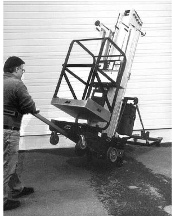
**Figura 4-6. Instalação do dispositivo de inclinação para trás.**
